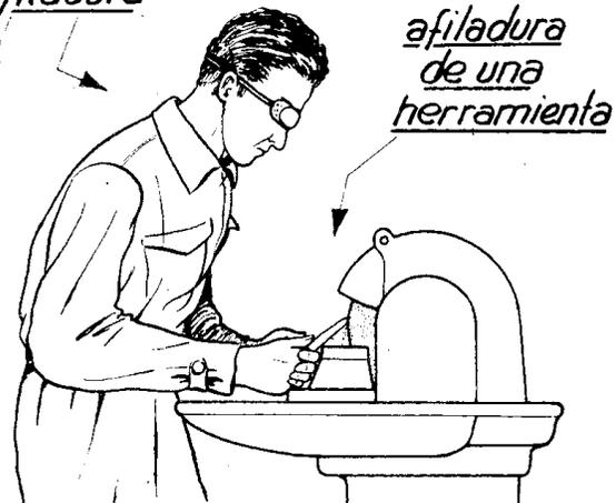
de la lima, con el objeto de reducir la porción que haya que limar. La afiladura de estas y de otras herramientas cortantes empleadas en los ajustes, se efectúa con amoladora. Después de afilados, los cortantes deben asentarse en piedras aceitadas para quitar las asperezas. -
