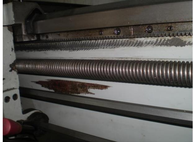
*En ambas fotografías se observan en perfil de la cremallera superior, que engrana con un piñón dentro del delantal para el avance automático longitudinal, el tornillo patrón en el centro, y la barra de avances debajo.*
